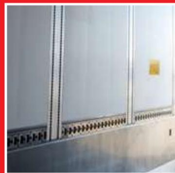
Rivestimento delle pareti in acciaio inox 12/10 completamente incassato, e cremagliere verticali per doppio piano di carico ad altezza variabile
