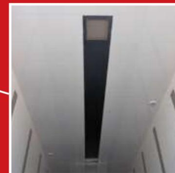
Canale incassato nel tetto e copertura in alluminio per unità di refrigerazione per seconda temperatura
