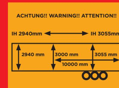
Struttura speciale pavimento e pareti laterali con due diverse altezze interne per l'esecuzione di mega-trailer per trasporto di 3-4 pallets JUMBO
