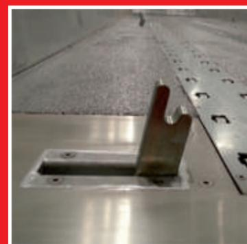
Sistema di 4 rulliere pneumatiche completamente incassate nel pavimento
