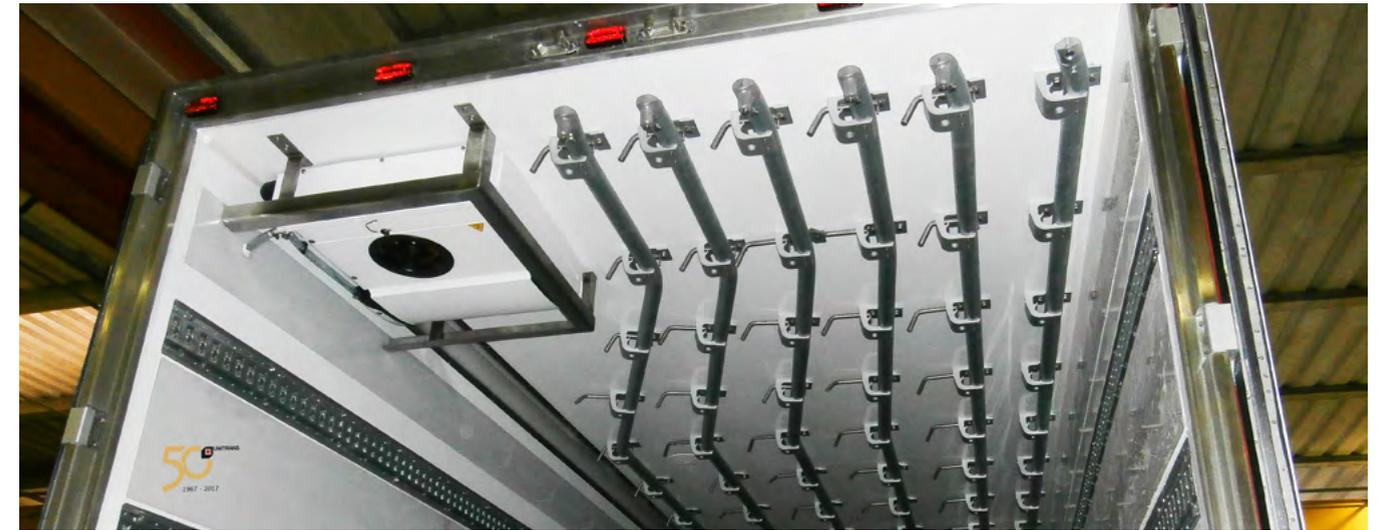
n. 5 tubovie in acciaio zincato dimensionate per l'alloggiamento del secondo evaporatore + sesta tubovia per recupero ganci in acciaio zincato, con supporti in alluminio e bulloni in inox, con sistema di cremagliere in acciaio zincato incassate per il piano di carico di 10 tonnellate lungo tutta la lunghezza
