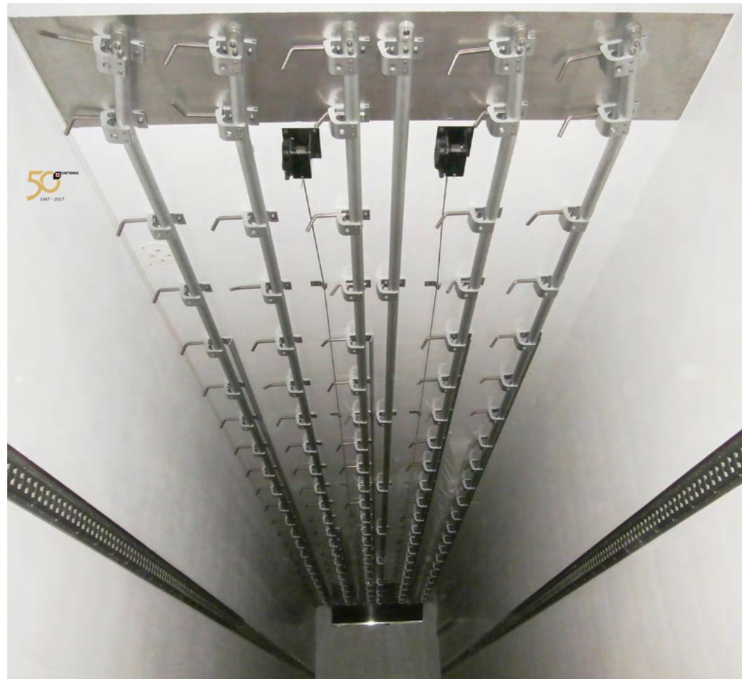
n. 5 tubovie in lega leggera di alluminio + sesta tubovia centrale + sistema di recupero ganci con 2 verricelli e protezione in acciaio inox sulla parte posteriore del tetto per mm. 500
