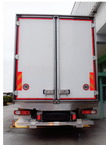
Riquadro posteriore sagomato Unitrans in acciaio inox spessore 4 mm, serie VR
